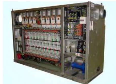
Convertidor Principal y Auxiliar 25 kVac IPM's (HST 350/AVE 102-112)
