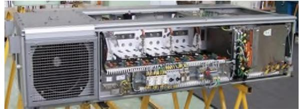
Convertidor Principal IGBT's. Bitensión 600/1500 Vcc
